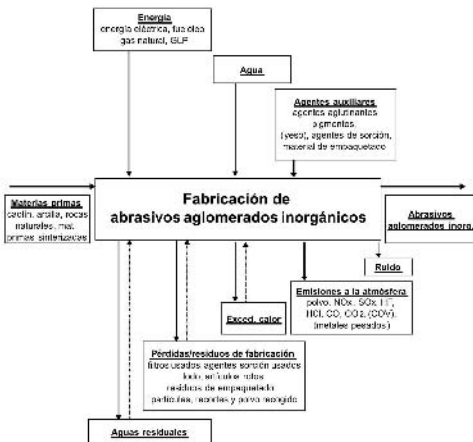
Figura 2.30. Flujos de entrada y salida en la fabricación de abrasivos aglomerados inorgánicos
