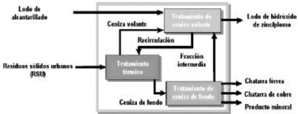
Figura 6.3. Componentes básicos de proceso PECK. [37, Biollaz, 2001]
