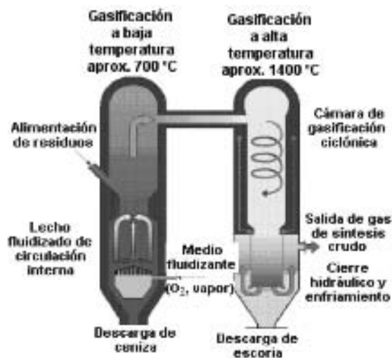
Figura 2.17. Gasificador de lecho fluidizado con horno de escorificación a alta temperatura. [68, Ebara, 2003]
