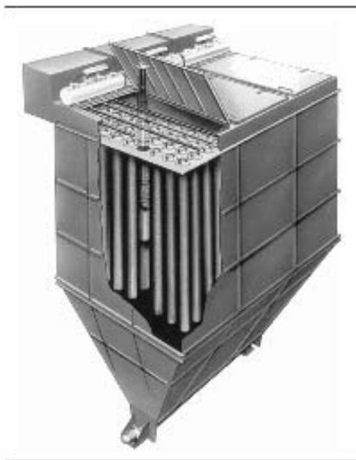
Figura 2.43. Un ejemplo de filtro de tejido. [1, UBA, 2001]
