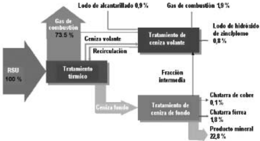
Figura 6.7. Balance de flujos de masa de materias para el proceso PECK.
